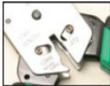
Odizolace kul. kabelů
